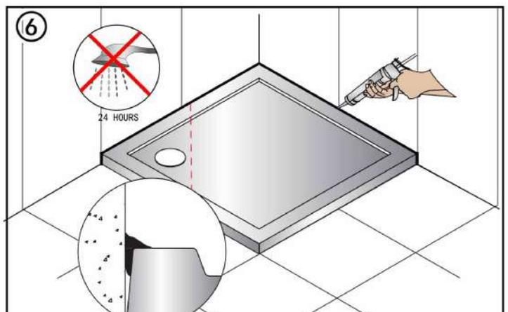
Faire des joints étanches entre le receveur et le mur avec du silicone anti-fongique et laisser reposer 24 heures.
