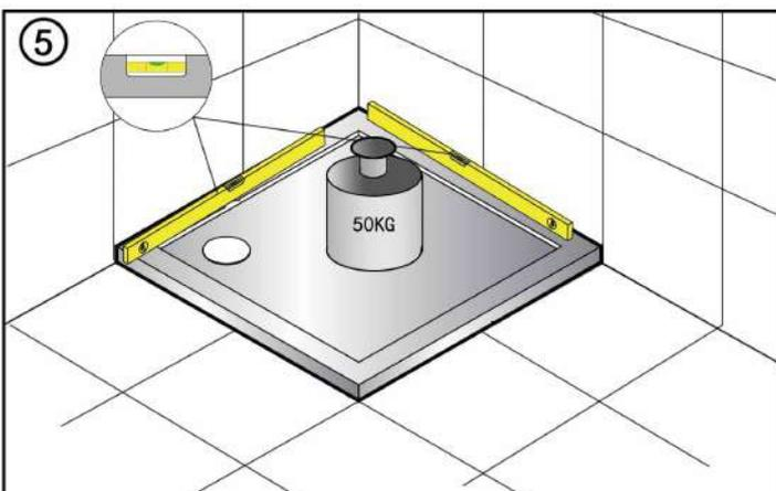
Mettre le receveur à niveau et laissez-le immobilisé pendant 24 heures.
