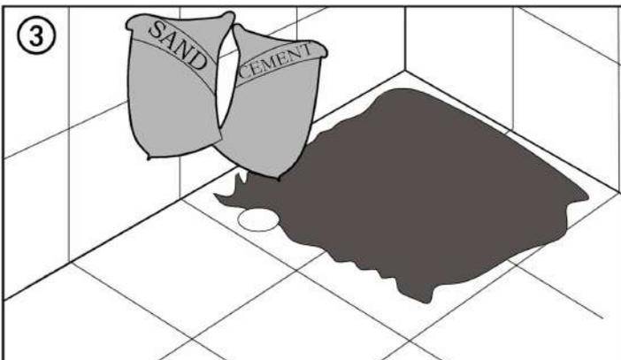
Installer le receveur sur une légère couche de ciment. Prenez note qu'en rajoutant de l'eau au mélange adhésif, le collage sera renforcé; il est conseillé d'appliquer une couche de base avant l'installation du receveur.
