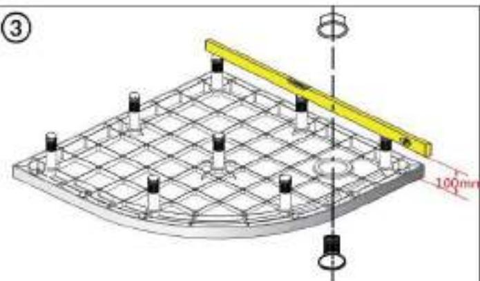
Retirer le film protecteur des zones qui seront contre le sol et des côtés du receveur qui seront contre un mur. La zone prévue doit être aux dimensions du receveur. Tous les pieds devront être à ajuster à une hauteur de 100mm.
