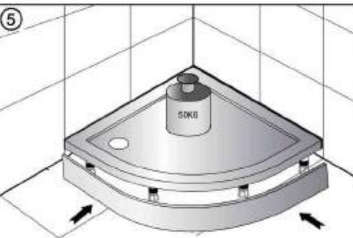
D'abord, fixer le tablier en le pressant fermement sur les attaches, puis fixer le panneau restant de la même manière.
