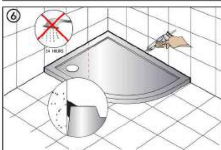
Faire des joints étanches entre le receveur et le mur avec du silicone anti-fongique et laissez reposer 24 heures.
