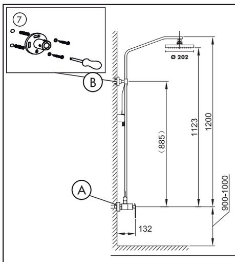
A - Dévisser les 2 vis de la barre, assembler le mitigeur à la barre, resserrer les vis après montage
